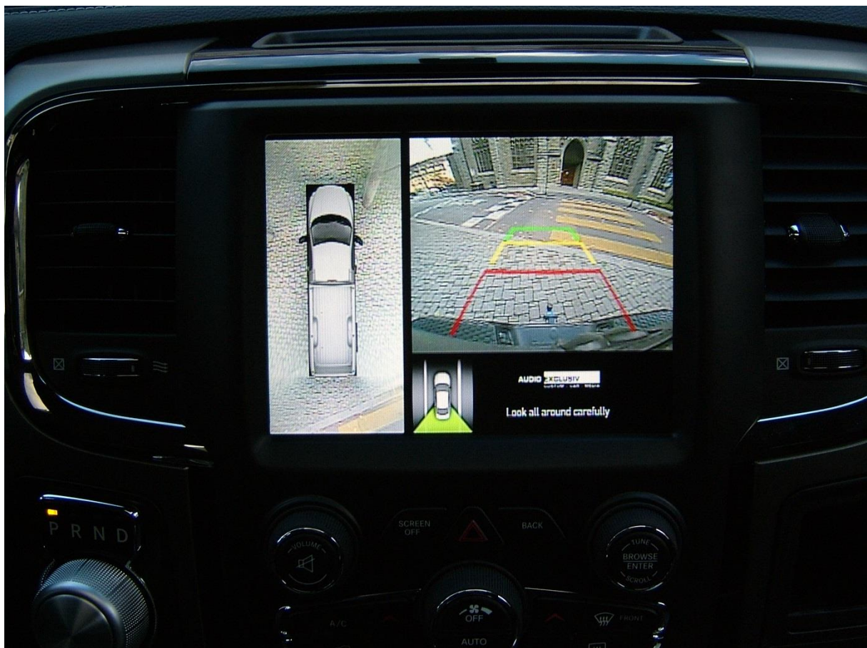
Bild: Ansicht der Heckkamera in einem Dodge Ram mit Uconnect.
