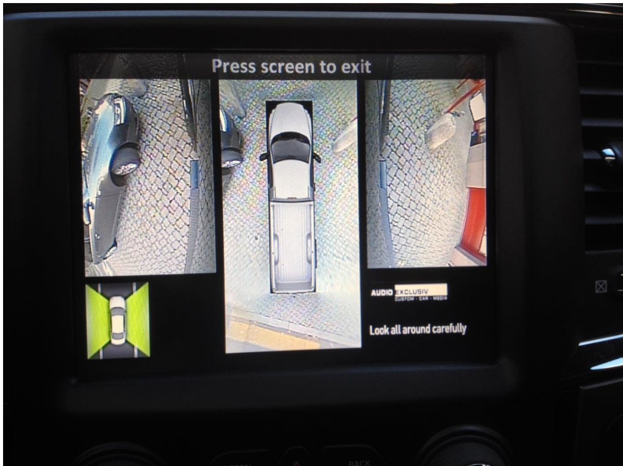
Bild: Die Ansicht der Seitenkamera lässt sich auf Knopfdruck umschalten.
