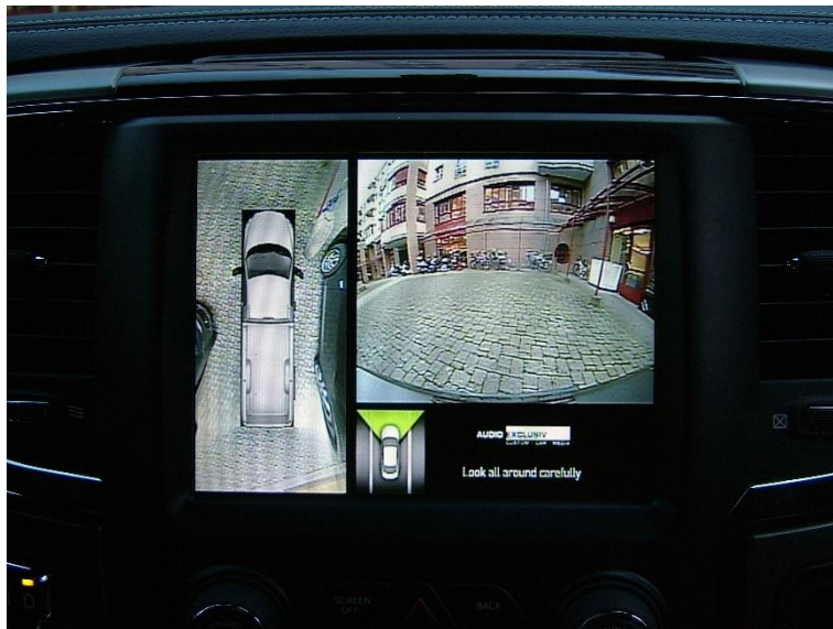
Bild: Top-View Kamera-System mit einem Original Gerät. Ansicht der Heckkamera.
