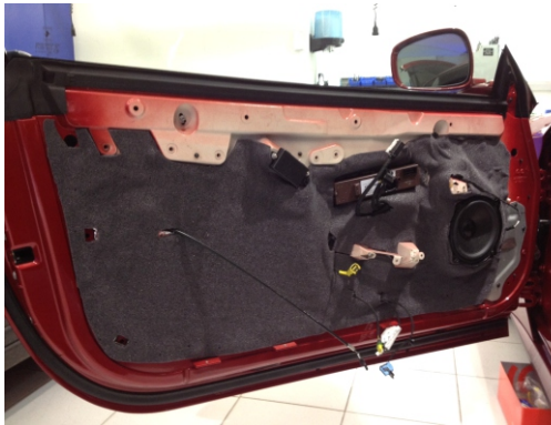
Die Türen werden komplett gedämmt
