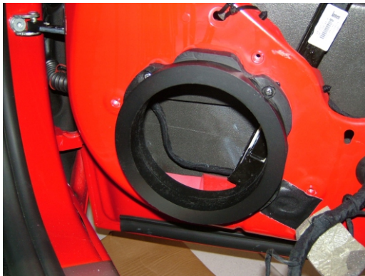
Türe Original ohne Bedämmung.
